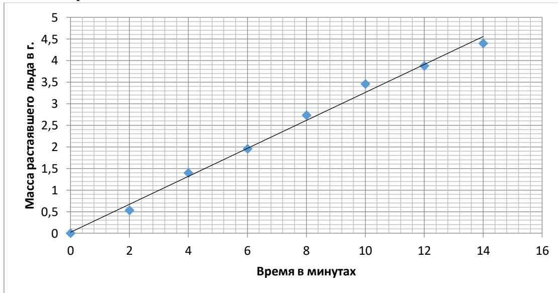
Угловой коэффициент графика  $\left( \frac{\Delta M}{\Delta \tau} \right)_1 \approx 0,32 \left( \frac{\text{г}}{\text{мин}} \right)$ . Коэффициент теплопередачи
